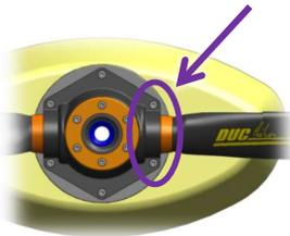
Une fois l'angle de calage désiré obtenu, resserrer légèrement les **vis d'assemblage du moyeu** au niveau du pied de pale, puis effectuer la même opération sur chacune des autres pales.
