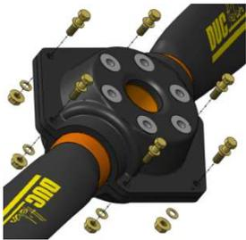
Depuis l'avant du moyeu, mettre en place les vis et rondelle d'assemblage. À l'arrière, placer les rondelles et écrous autobloquants.
