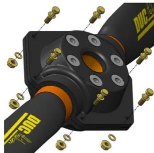
Depuis l'avant du moyeu, mettre en place les 6 vis et rondelle d'assemblage. A l'arrière, placer les rondelles et écrous autobloquants.
